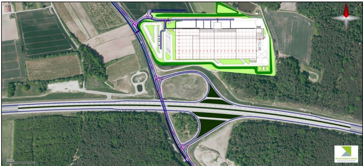
Abbildung 5: Netzmodell (blaue Streckenlinien) des untersuchten Verkehrssystems bei zukünftigem Ausbaustand (Kartengrundlage: [4])
